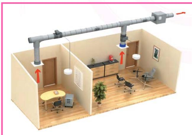
**Exemple solution MULTIZONE avec sonde PRESENCE**
