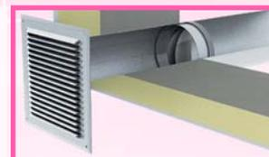
Les clapets anti-retour **CAR** sont réalisés en acier galvanisé embouti pour les diamètres 80 à 200 mm, soudé et moleté pour les diamètres 250 à 400 mm. Destinés à équiper les installations de ventilation fonctionnant de manière ponctuelle, ils permettent d'éviter l'entrée d'air dans les locaux en cas d'arrêt du ventilateur.
