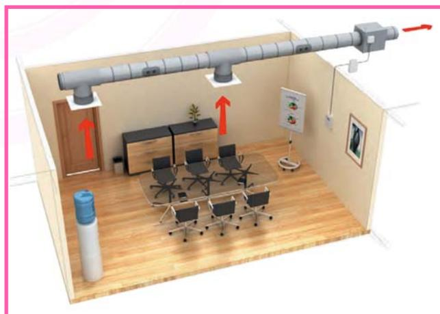
**Exemple solution MONOZONE avec sonde CO<sub>2</sub>**
