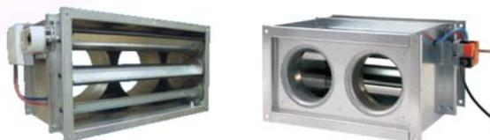
Le régulateur de débit électronique ou pneumatique VRRM se compose d'une plaque de régulation, d'un registre à ailette et d'une ou plusieurs buses de mesure de débit, celle-ci mesure la pression différentielle qui correspond à une grandeur physique définie permettant de calculer le débit, la vitesse peut ainsi être mesurée sans avoir recours à des moyens empiriques et à des sondages.
