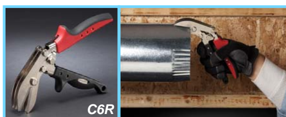
C6R Permet de sertir les tubes afin de réduire leurs diamètres dans les espaces confinés ou le travail en hauteur
