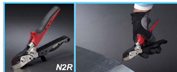
N2R Permet de réaliser rapidement des entailles en V de 1" (25,4mm) de profondeur dans une tôle afin de la plier facilement
