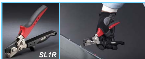
SL1R Permet d'assembler de manière économique les tôles de métal, le poinçonnage soulève une saillie sur le rebord en métal, permettant de s'emboîter dans le rebord roulé de la tôle devant être jointe
