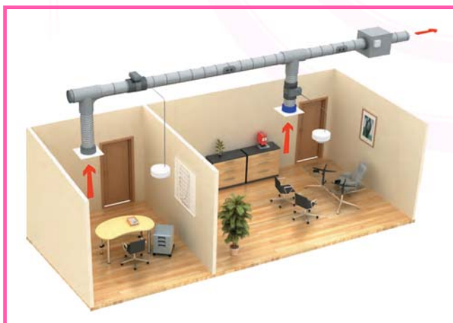
Exemple solution MULTIZONE avec sonde PRESENCE
