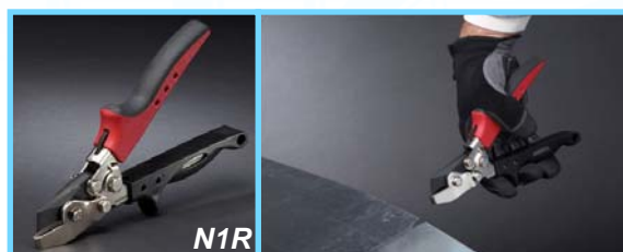
N1R Permet de réaliser rapidement des entailles en V à 30° de 20,6mm de profondeur dans une tôle afin de la plier facilement
