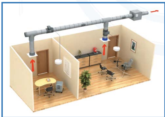
Exemple solution MULTIZONE avec sonde PRESENCE
