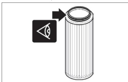
4 - Vérifier que les parois de la cartouche ne comportent ni déchirures ni coupures. Il sera nécessaire de remplacer la cartouche endommagée par une nouvelle cartouche.
