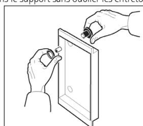
**5** - Fixez solidement la plaque de fixation avec les vis et chevilles appropriées **6** - Démontez le bac à poussière **7** - Fixez la centrale sur la platine murale en la faisant coulisser sur la droite.
