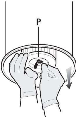
3 - Insérer une nouvelle cartouche et visser à fond l'écrou sans forcer exagérément.
