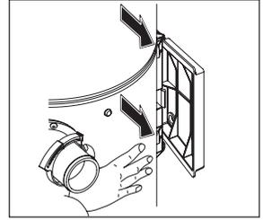
**8** - Vérifiez l'accrochage correct (verrouillage de la languette) **9** - Montez à nouveau le bac à poussière
