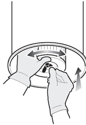
4 - Montez à nouveau le bac à poussière en faisant attention à la position du joint d'étanchéité. Raccrocher le bac à poussières.
