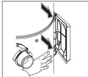
**8** - Vérifiez l'accrochage correct (verrouillage de la languette) **9** - Montez à nouveau le bac à poussière
