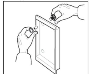
**5** - Fixez solidement la plaque de fixation avec les vis et chevilles appropriées **6** - Démontez le bac à poussière **7** - Fixez la centrale sur la platine murale en la faisant coulisser sur la droite.
