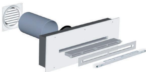
Le **STM** se monte horizontalement ou verticalement dans tous les doublages après avoir effectué le percement du mur et scellé un manchon Ø 125 mm.
