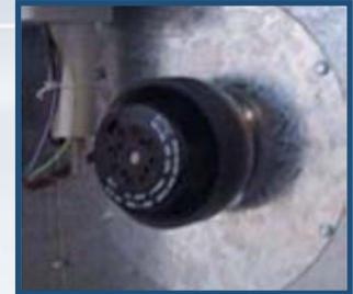
MOTEUR SKAGEM HORS VEINE D'AIR
