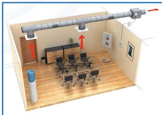
**Exemple solution MONOZONE avec sonde CO<sub>2</sub>**
