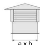
Les prises d'air CDQ-A et CDQ-B sont utilisées dans les réseaux d'insufflation, elles sont équipées d'un grillage anti-volatile pour les modèles type A et de ventelles anti-salissure et d'un grillage anti-volatile pour les modèles type B.
