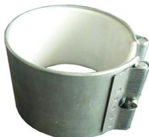
Les colliers UK permettent l'assemblage économique et démontable de gaines spiralées simple peau de petit Ø (maxi Ø 315mm), de ventilateurs de conduits ainsi que l'étanchéité à l'eau sur les réseaux de gaines spiralées double peau.
