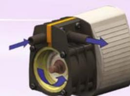
Les condensats sont aspirés vers la pompe et chassés mécaniquement à travers un diaphragme rotatif en élastomère renforcé d'où ils sont évacués sous pression. Ce système tolère même les petites particules en suspension ainsi que les eaux de condensats peu gluantes.
