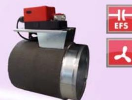
Registres motorisés avec servomoteurs intégrant la nouvelle technologie **EFS** (Sécurité Electronique Intégrée), fermeture par manque de courant sans ressort mécanique remplacé par un condensateur à charge rapide ramenant le registre dans une position de fermeture prédéfinie, le tout avec une consommation électrique réduite et utilisant des boîtiers très compacts.
