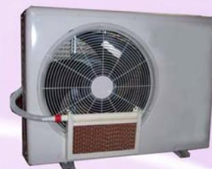
Système innovant qui permet d'éliminer l'eau issue d'un condenseur. L'eau s'infiltre dans les différentes couches du **VAPOBOX** et s'évapore grâce à la chaleur et la ventilation produite par l'unité extérieure.
