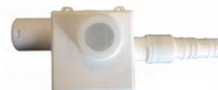
Siphon de très petite taille fabriqué en PVC, pour installation horizontale ou verticale, créant une barrière contre les mauvaises odeurs des condensats, raccord d'entrée pour tubes rigides Ø20mm et sortie en souple multi diamètre Ø20 à 32mm, bouchon d'inspection en face avant.
