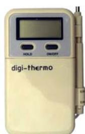
Thermomètre digital à sonde
