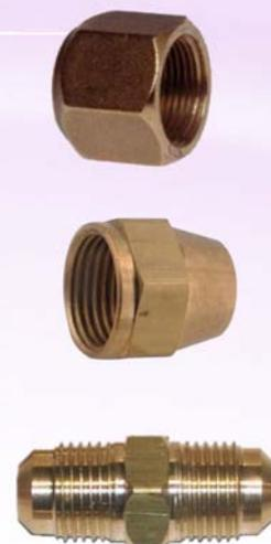
Sur les raccords de type FLARE (évasé) l'étanchéité se fait par le serrage d'un écrou laiton qui emprisonne l'évasement cuivre du tube frigorifique (dudgeon).
