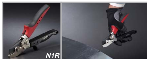
Permet de réaliser rapidement des entailles en V à 30° de 20,6mm de profondeur dans une tôle afin de la plier facilement
