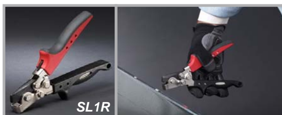
Permet d'assembler de manière économique les tôles de métal, le poinçonnage soulève une saillie sur le rebord en métal, permettant de s'emboîter dans le rebord roulé de la tôle devant être jointe
