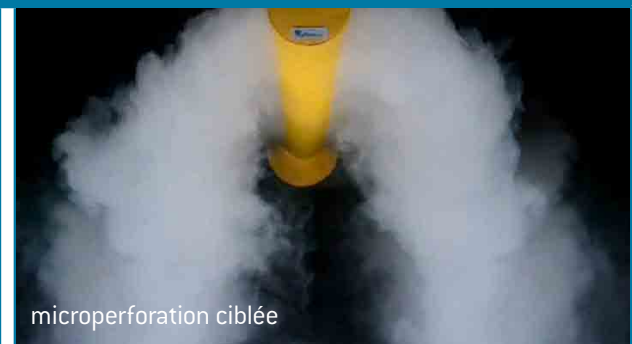
Des exemples de modèles de flux d'air créés à l'aide des tests de fumée dans le centre PRIHODA R&D
