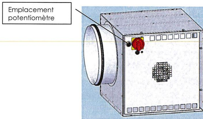
En cas d'incendie, le même système validé par le procès-verbal de référence, thermocontact positionné contre la plaque de cloisonnement interne côté moteur, assurera la mise en action du système marche ou crève du moteur, shuntant le potentiomètre.
