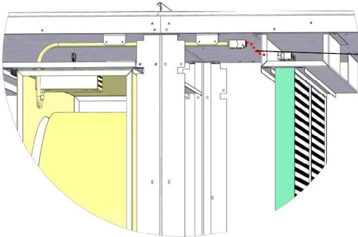
Raccorder les connecteurs situés entre les 2 modules
