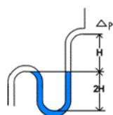
**Sur chaque tube d'évacuation de condensats, prévoir un siphon.** Un siphon ne peut pas être utilisé pour plusieurs évacuations. Attention : le siphon doit être raccordé dans les Règles de l'Art afin d'assurer une évacuation optimum des condensats.
