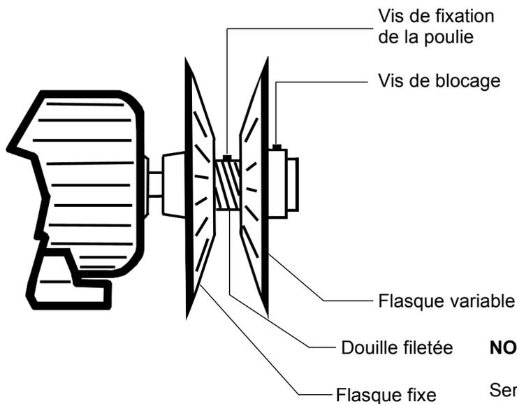
La flasque variable de la poulie est vissée sur une douille fileté. Avant de changer sa position, desserrer la (les) vis de blocage avec une clé mâle coupée pour vis à six pans creux. Visser ou dévisser la flasque variable sur la douille fileté afin d'obtenir le diamètre désiré. Après le réglage, resserrer les vis de blocage en veillant bien à serrer cette (ces) vis sur le(s) méplat(s) de la douille fileté.
