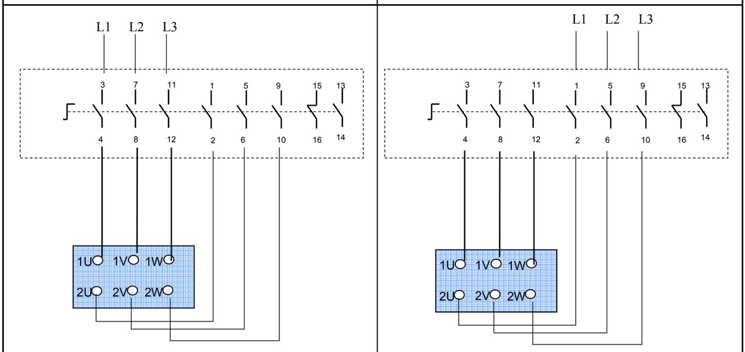
**IV / CABLAGE ELECTRIQUE MOTEUR ATTAQUE DIRECTE (CBI)**
