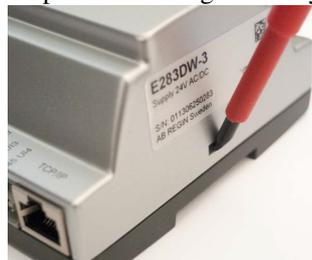
Appuyer sur les clips de chaque côté du boîtier avec un petit tournevis pour desolidariser le couvercle du socle. Maintenez le
