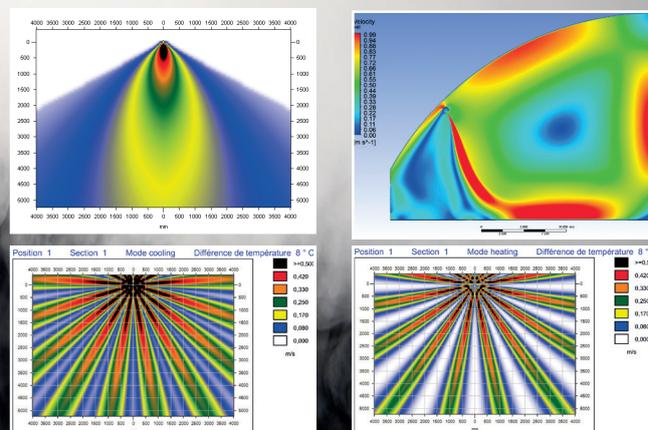
Chaque projet est dimensionné au cas par cas avec un logiciel spécifique permettant de simuler toutes les caractéristiques de diffusion en rafraîchissement et en chauffage.
