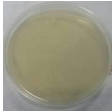
Figura 1.3) Foto di piastre con terreno LB rimosse, dopo 5 ore, dalla scarpiera col dispositivo fotocatalitico funzionante: le colonie di microrganismi sono poco evidenti
