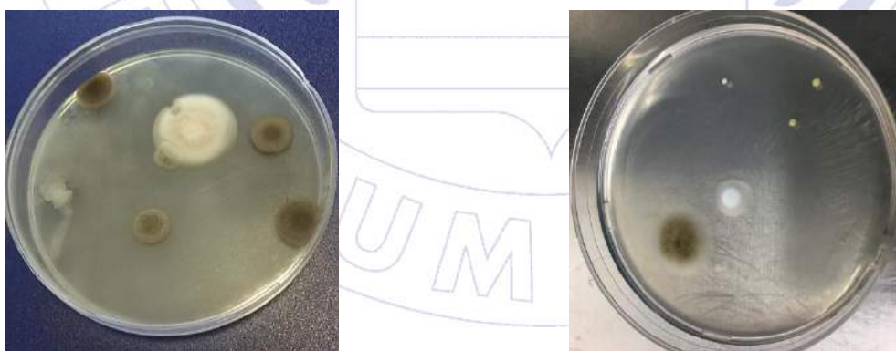
Figura 6. Confronto tra piastra YPD senza dispositivo in funzione (a sinistra) e con dispositivo in funzione (a destra) dopo 6 h esposizione all'aria, in posizione A4
