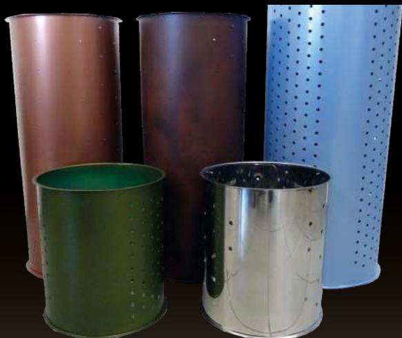
Gaine circulaire micro perforée de diffusion d'air à effet inductif. Conçue pour diffuser l'air dans les locaux où de grands volumes d'air sont nécessaires avec une vitesse minimale de mouvement et un confort maximum, en exploitant le jet à induction généré par les trous sur la surface de la gaine.
