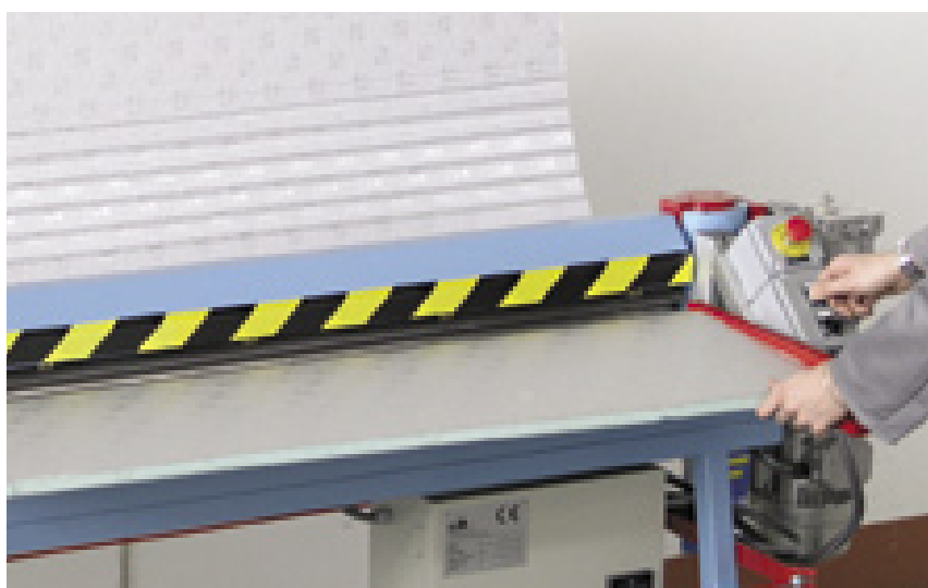
[Détails du calandrage que l'on peut obtenir avec la cintreuse électrique]
