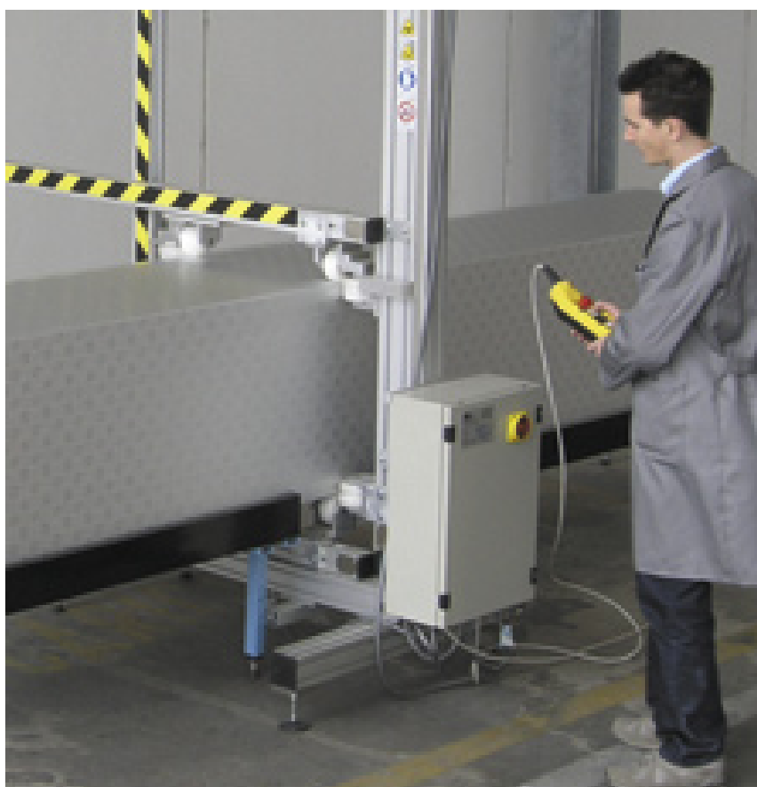
[Détail du mécanisme de fermeture et de la commande à distance à fil]
