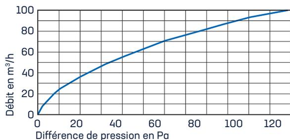
La courbe ci-contre donne les caractéristiques aérauliques nominales en fonction du taux d'humidité de l'air intérieur et pour une différence de pression de 20 Pa.
