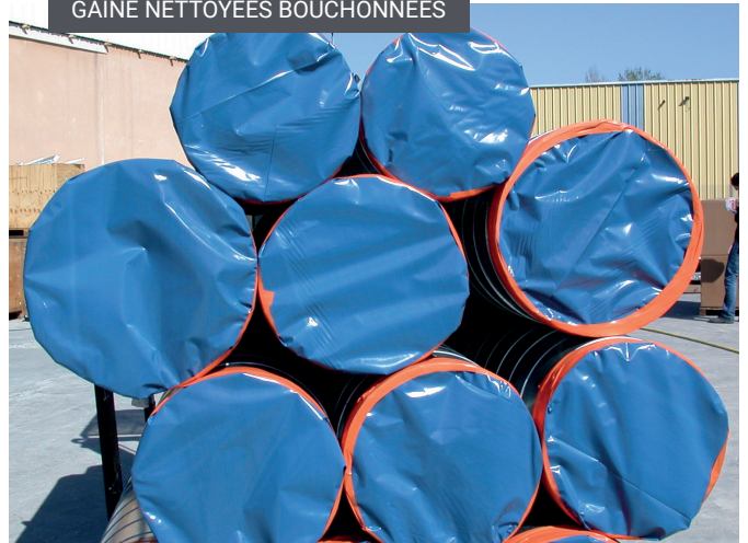
GAINE NETTOYÉES BOUCHONNÉES
