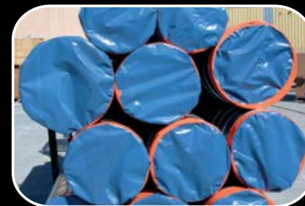
Gaines nettoyées bouchonnées
